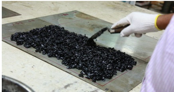
ภาพที่ 2 แสดงการทดสอบ Flow Down Test
